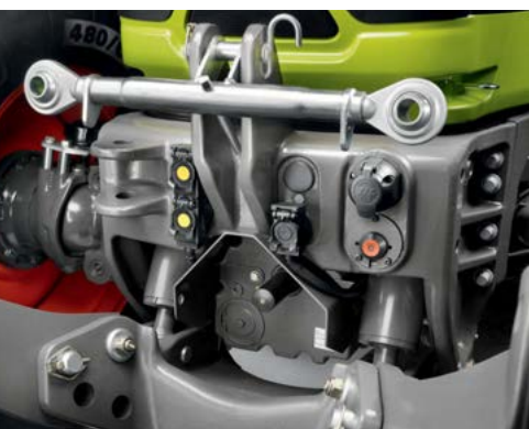
La parte delantera de la gama ARION 400 integra múltiples conexiones que facilitan todas las opciones de acoplamiento.
