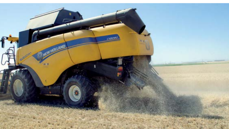
La cosechadora New Holland CX8080 es una máquina de última generación y grandes prestaciones con sistema de doble trilla convencional.
